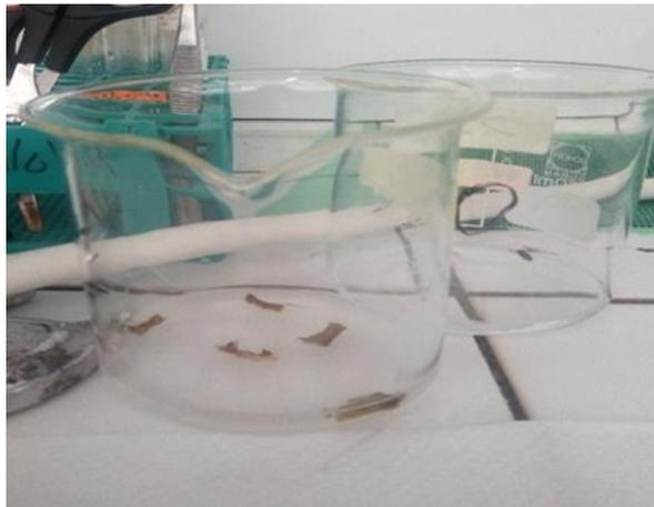
**Figure 13** : Désinfection de l'échantillon à l'hypochlorite de sodium.
